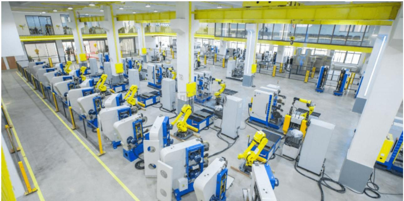
高尔夫球杆头打磨生产线，包括夹持式机器人、砂带机与物料台，夹持式机器人上设有夹具组件，夹持式机器人通过夹具组件执取待打磨的高尔夫球杆头，并从物料台转移至砂带机上进行打磨，砂带机包括机架，机架上设有至少两组砂带机构，砂带机构包括柔性打磨组件、驱动轮、砂带，柔性打磨组件包括固定支架、活动支架、砂带轮，固定支架、活动支架之间设有活动轮，固定支架上设有驱动电机，驱动电机设有缓冲导轮，活动支架设有摆动座，摆动座中部开设有拱形槽，缓冲导轮设置在拱形槽内，活动支架的侧端设有回位拉簧，活动支架通过回位拉簧使活动支架在打磨后回位。
