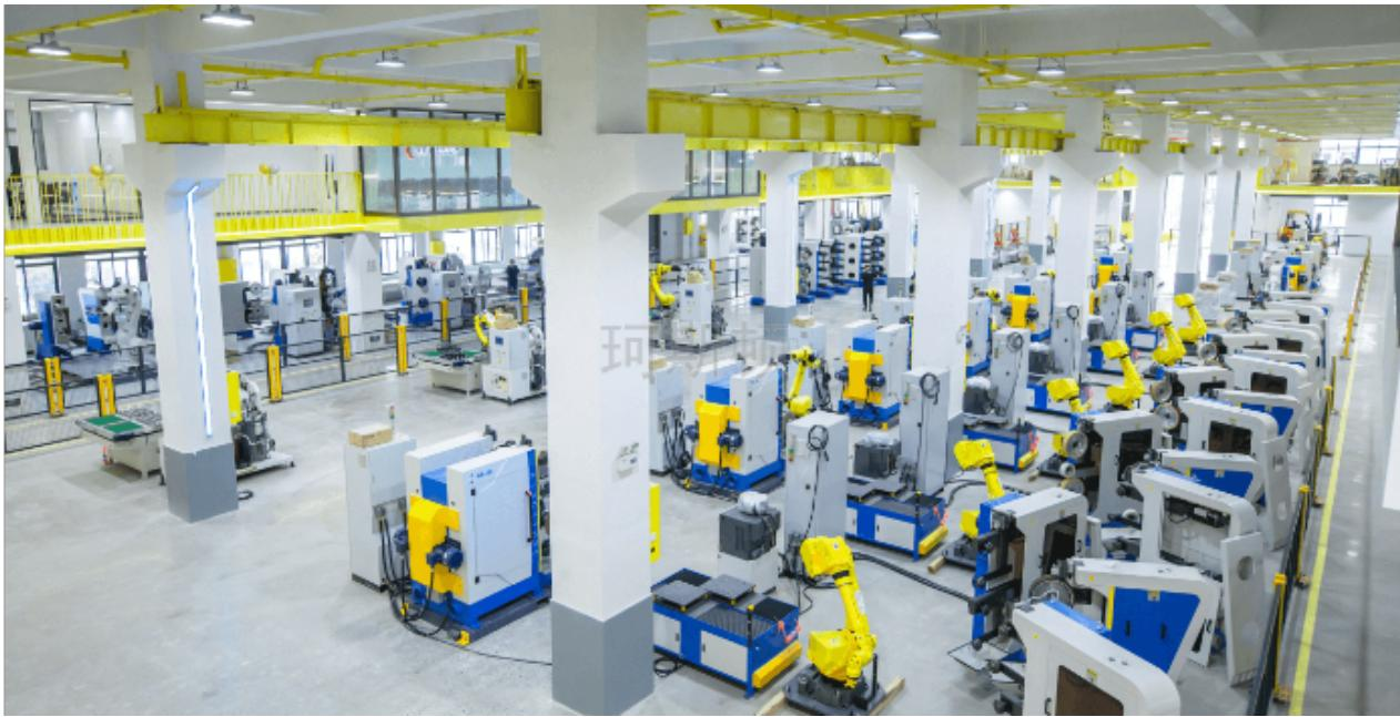
什么是打磨机器人？打磨机器人一般是由示教盒、控制柜、机器人本体、压力传感器、磨头组件等部分组成，可以在计算机的控制下实现连续轨迹控制和点位控制。打磨机器人的具体应用：1、末端刀与打磨路径去除工件毛刺抛光打磨机器人代替人工进行金属工件去毛刺作业，这有利于降低人工操作技术的要求。以五金金属铸件为例，这些五金金属铸件都要求表面光滑且无残留的金属毛刺，抛光打磨机器人可以利用打磨工具末端的刀以及运动路径去除毛刺，这对于减少人工以及减少设备的应用都具有很大的优势。2、多层焊缝打磨时滤除焊缝与氧化层抛光打磨机器人还频繁应用于焊缝打磨作业中。一般来说多层焊缝打磨需要滤除不规则的焊缝、飞溅以及氧化层，从而确保焊接表面能进行平滑过渡并且获得更好的焊接质量，除此之外在进行焊缝打磨作业时，抛光打磨机器人还会避免产品表面出现气孔或者夹渣现象。浙江珂斯顿机器人科技有限公司致力于提供机器人打磨抛光，有想法可以来我司咨询！杭州小型打磨机器人打磨抛光机
